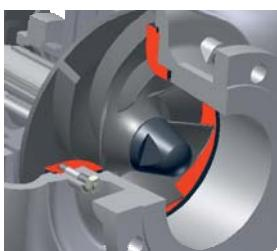
**La PIASTRA DI USURA SOSTITUIBILE** garantisce lunga vita alla pompa e riduce i costi di manutenzione. Inoltre il supporto è dotato di **REGISTRAZIONE ASSIALE** dei **GIOCHI**, che possono essere variati operando da lato comando.
