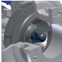
**OGNI GRANDEZZA HA UN SOLO CORPO** che può essere utilizzato per la girante chiusa (con collare d'usura) e girante aperta (con piastra di usura sostituibile). Questo consente, con semplici operazioni, di adattare la pompa a nuove esigenze d'impianto e processo.
